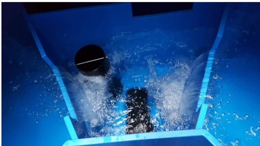
*Fig 1 Foto camera Guglielmoni a Curio dove vengono effettuate le misure- 16 luglio 2017 645 l/min*
